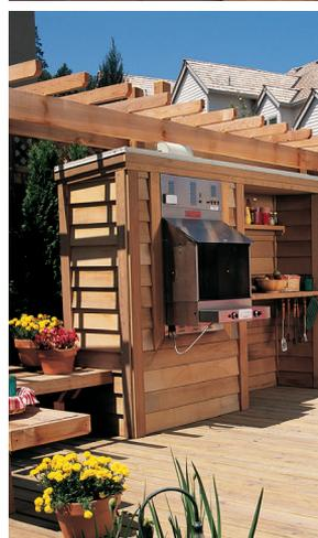
本質的に耐久性のある西部産樹脂よりも強靱で、防腐剤により防腐加工を施すことが容易なヘム/ファーは、屋外の施設など、荷重がかかる部材としても、また非構造的部材としても有用です。構造枠組材として経済的な選択肢。他の木材と似せるためステインを塗ることもできます。
