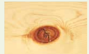
Mata Kayu Retak Radial
